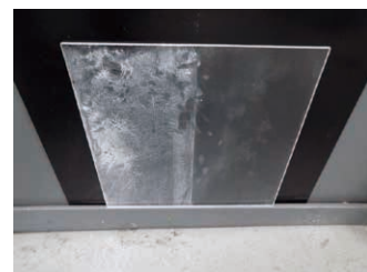
帯電性試験 左:未塗装、右:塗装
